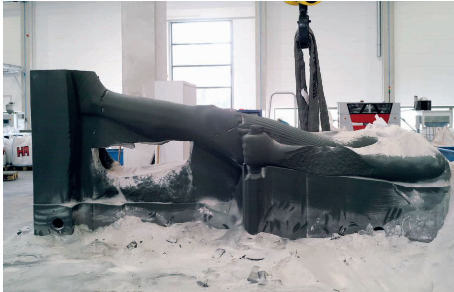
الطباعة الرملية ثلاثية الأبعاد لتهارقا في فوكسلجيت، فرايديبرغ/ألمانيا، يوليو 2014
